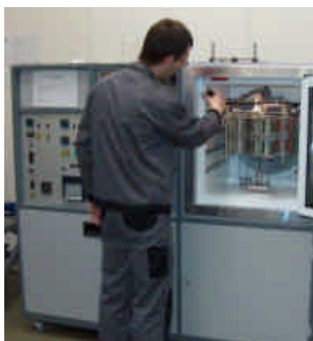
Figur 1: Anbringelse af testemner i ozonskab i forbindelse med accelereret test.
